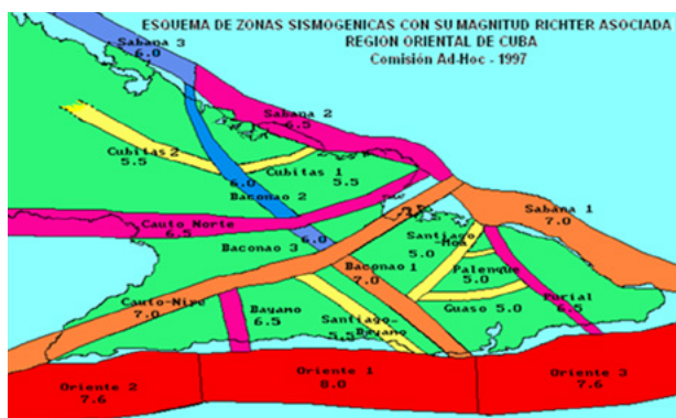
Figura 1.2. Esquema de Zonas Sismogénicas de la región Oriental de Cuba, (Fuente: Chuy et al 1997).
