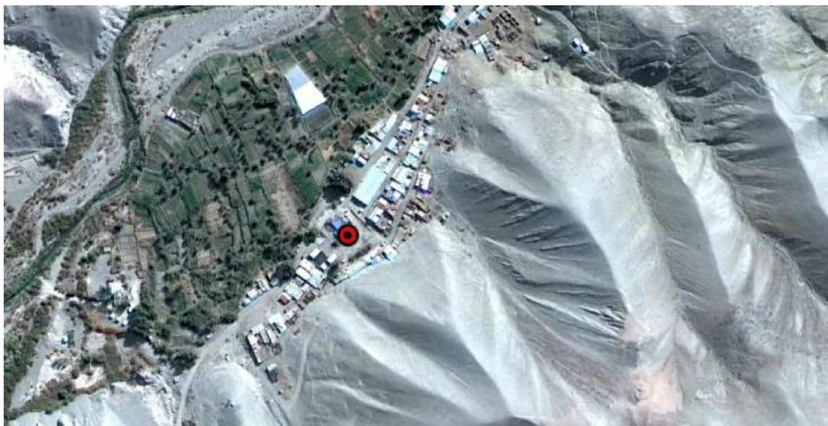
**Figura 30.** Emplazamiento de la iglesia de Laonzana (punto rojo) y del pueblo que han generado un corte en el cerro y un posible aumento de la cantidad de agua en el suelo por la presencia de desagües sin regulación. Fuente: Google Earth.
